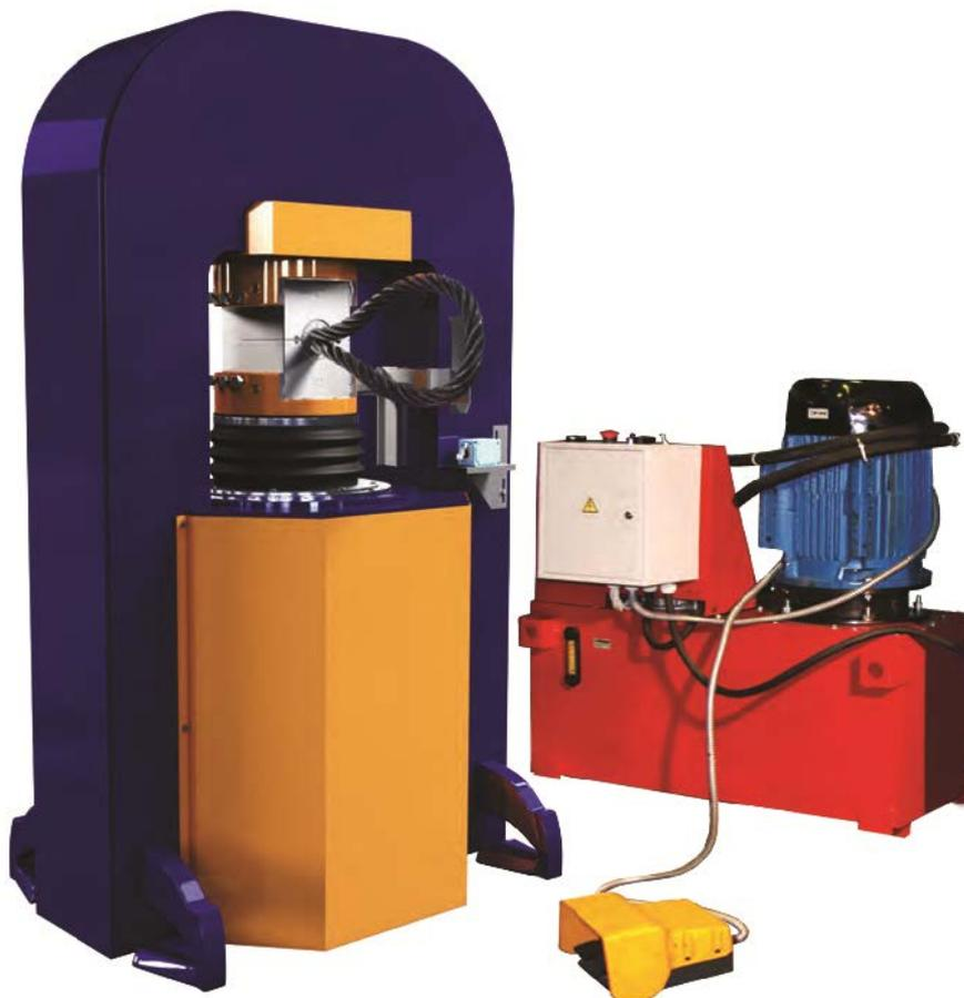
Высокопроизводительные профессиональные комплексы ADV-600E и ADV-400E предназначены для заделки концов стальных канатных стропов опрессовкой металлической втулкой; для опрессовки концов канатов с использованием полной номенклатуры опрессовочных аксессуаров принятой в мировой практике при серийном производстве; обеспечивают наивысшее качество опрессовки.
