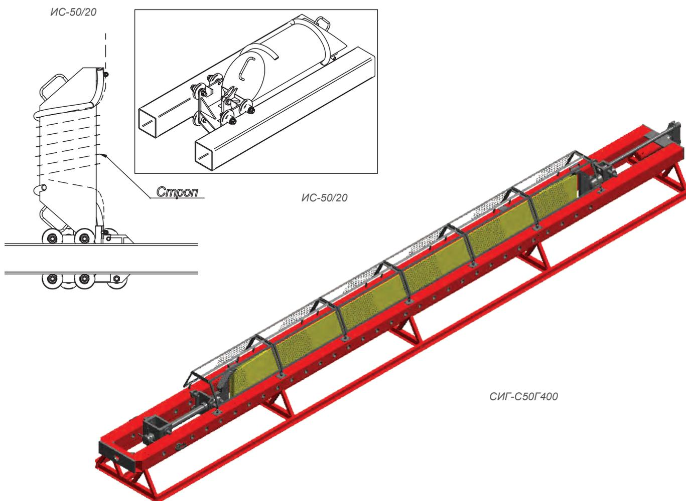
Приспособления для испытания стропов
