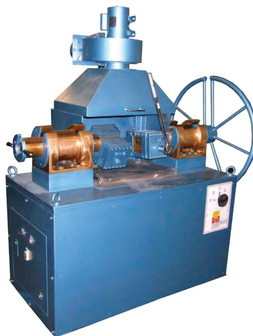
Станок для прокаливания и закручивания конца каната СПЗ-36
