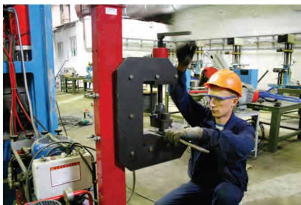
Маркировка стропа на обжимной втулке на оборудовании УКГ-8П в цехе по производству стальных канатных стропов ОАО «Белорецкий металлургический комбинат»
