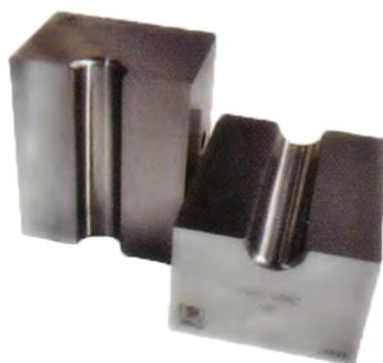
Матрицы для опрессовки концевых обжимных муфт
