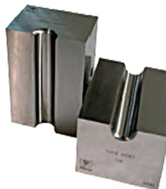
Открытые матрицы для опрессовки стальных втулок Flemish Eye методом 2-х стадийной опрессовки, 1-я стадия
