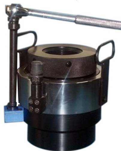
С возвратом поршня за счет упругих напряжений в шпильке
