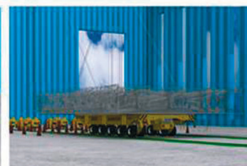
Переместить секцию судна судовым транспортёром в покрасочный цех
